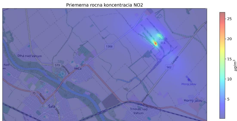
Obr. 6.1.5 Priestorové rozloženie príspevku zdrojov v areáli Duslo a. s. k priemernej ročnej koncentrácii \text{NO}_2 , modelované pomocou modelu ATMOPLAN.
