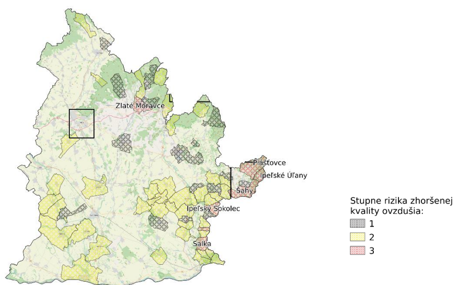
Obr. 4.5.1 Zóna Nitriansky kraj s vyznačenými hranicami obcí zaradených medzi oblasti riadenia kvality ovzdušia na základe metódy integrovaného posúdenia. Čiernym obdĺžnikom sú označené domény modelované modelmi s vysokým priestorovým rozlíšením.
